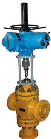
Трёхходовые клапаны КТС/КТР предназначены для смешивания/разделения в заданной пропорции потоков как нейтральных, так и химически активных жидкостей и газов при рабочих давлениях (PN) 1,6; 2,5; 4,0; 6,3; 10,0; 16,0 МПа, вне зависимости от общего расхода, до перепада, равного условному давлению клапана.
